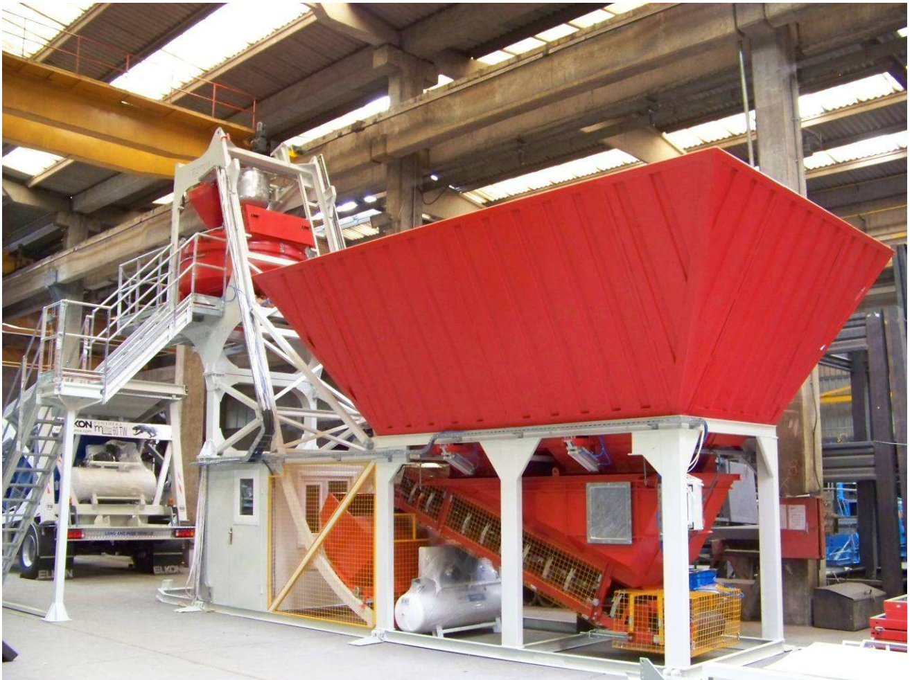
Pozycja robocza ELKON QUICK MASTER -35 W Pełni Automatyyczna Betoniarnia
